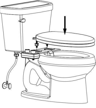
5. Installare il sedile del WC
